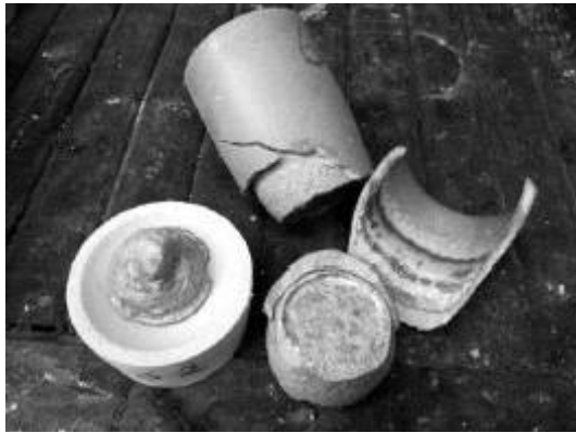
სურ. 6. A,B. ოქროს მატარებელი ტყვიის ზოდი გამზადებული კუპელაციისათვის. ფორებიან MgO ტიგელში კუპელაციის შემდეგ ტყვიის ოქსიდი შეიწოვება ტიგელის მიერ (რომელიც ამჟამად მოყვითალო ფერისაა) და რჩება ხალასი ოქრო. ოქროს ძარღვები შეიცავენ 6-7 გ/ტ ოქროს ხოლო საყდრისის დანაყარი 6-7 გ/ტ ოქროს, ერთეულ შემთხვევებში 22 გ/ტ-ს. ცეცხლით გახურების მეთოდით ექსპერიმენტის დემონსტრირება ჩაატარეს დოქტორ ვ.ჰონერმა, დორტმუდმა და სერგო ნადარეიშვილმა; სერგო ნადარეიშვილის ფოტო, თბილისი.
