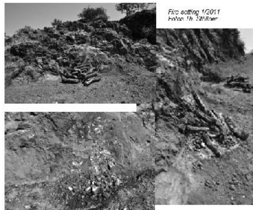
სურ. 16. ცეცხლით გახურებით მად- ნის მოპოვება. ექსპერიმენტი. 2011 თ.შტოლნერის ფოტო
