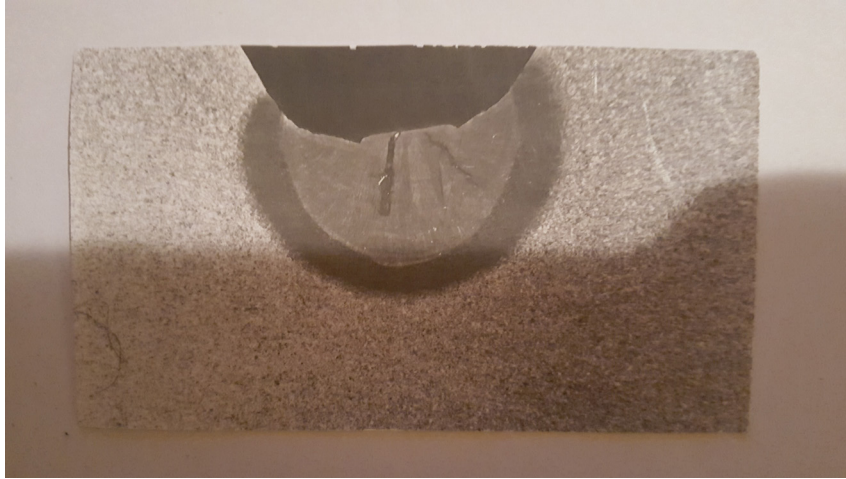
ნახ.5. სერიული СБ-08XF2CMΦ საშემდუღებლო მავთულით შედუღებული ნიმუშის დეფექტები ხისტი ჩამაგრების შემთხვევაში.
