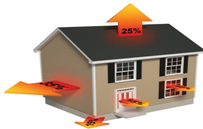
სურ. 1. შენობის შემომზღუდავი კონსტრუქციებიდან ენერჯის დანაკარგების პროცენტული განაწილება
