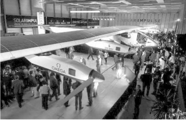
Второй прототип оказался больше предыдущего. Размах его монокрыла, покрытого тысячами солнечных элементов, достигает 72-х метров. Это всего на семь метров меньше, чем у аэробуса A380. Вес «Солнечного импульса» составляет 2,3 тонны.
