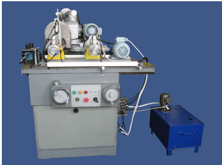
სურ. 1. კერამიკული ფილების საყრდენი ზედაპირებისა და პერიმეტრის ალმასური ხეხვის სპეციალური ჩარხი
