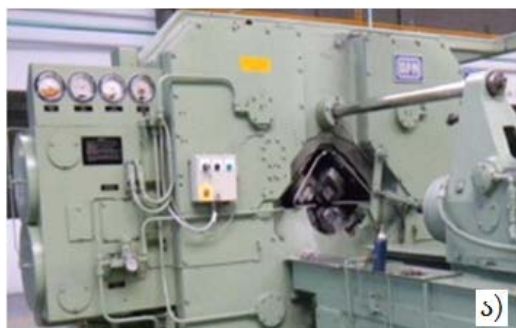
სურ.10. რადიალურ-საჭედი მანქანა (ფირმა GFM - ავსტრია): ა – მანქანის წინხედი; ბ – დეფორმაციის ზონა
