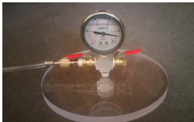
სურ. 5. ხუფი ჩამონტაჟებული ბარომეტრით
