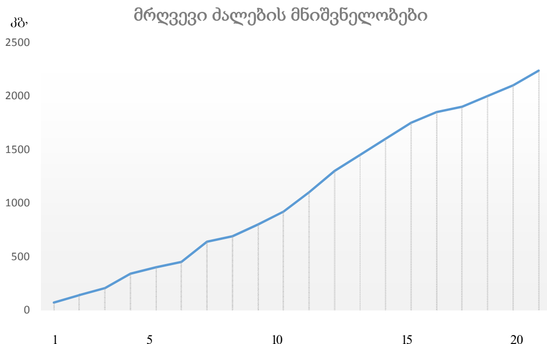
სურ. 3. ზღვრული გამჭიმავი ძალის დამოკიდებულება (კბ ორდინატაზე) კომპოზიტის ფენების რაოდენობაზე
