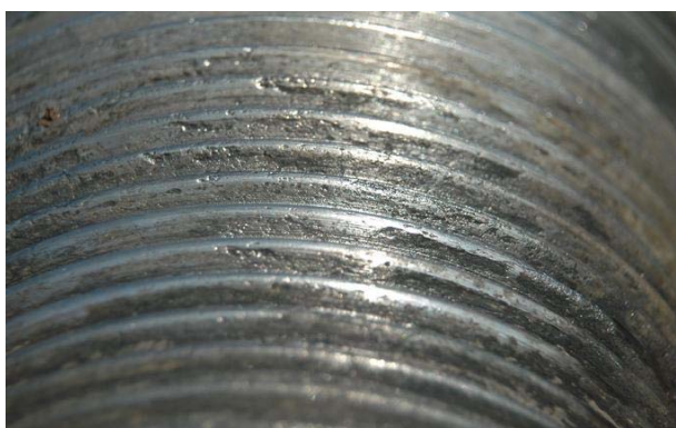
სურ. 2. კოროზიული დაზიანება პიტინგი, გამოწვეული ხსნარში საბურღ მილზე კოროზიული აირის ზემოქმედებით
