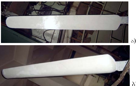
სურ.1. ბაზალტის ბოჭკოვან-კომპოზიციური მასალის ფრთა ა) წინა ზედაპირი; ბ) უკანა ზედაპირი
