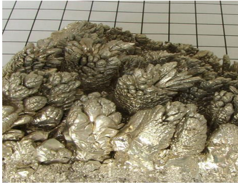
სურ. 17. მაგნიუმის ხელოვნური დენდრიტი, რომელიც მიიღება მაგნიუმის ორთქლის კონდენსაციით ცივ ზედაპირზე. ძალიან გავს ნაძვის გირჩების გროვას
