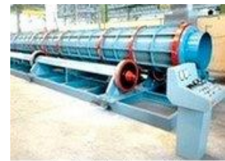
სურ. 2. ბეტონის ცენტრიფუგირება
