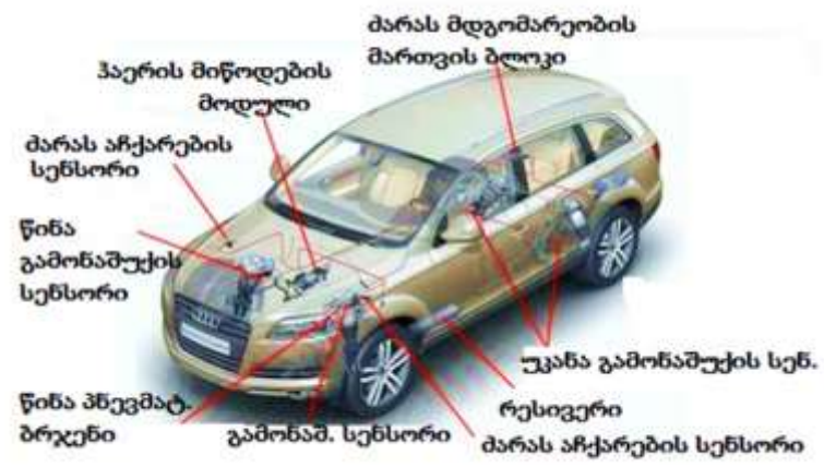
ნახ. 3. Audi Q7 აქტიური პნევმატიკური დაკიდების სისტემა
