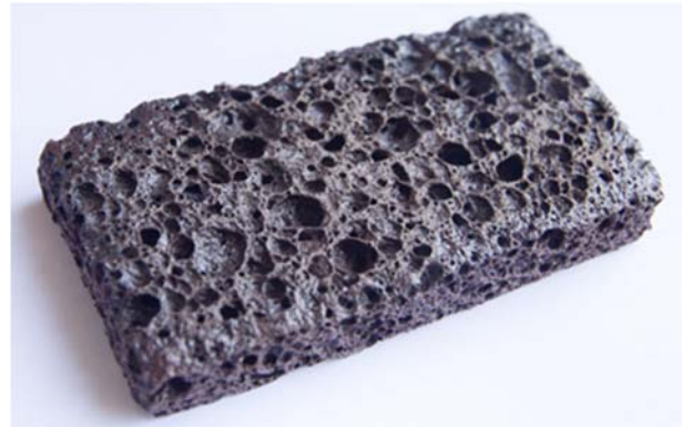
სურ.4. თიხაფიქლების საფუძველზე მიღებული ფორიანი თბოსაიზოლაციო მასალა
