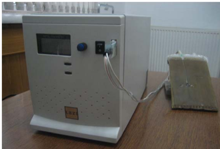
სურ. 5. მართვადი ლოკალური ჰიპერთერმიის მეთოდით სიმსივნური დაავადებების სამკურნალო აპარატი "ლეზი". დამზადებულია საქართველოს ტექნიკური უნივერსიტეტის ბიონანოკერამიკისა და ნანოკომპოზიტების მასალათმცოდნეობის ცენტრში (ხელმძღვანელი პროფ. ზ. კოვზირიძე)
