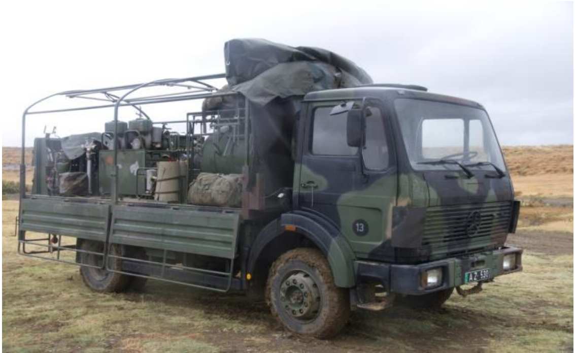
ფიგ.51 სპეციალური დამუშავების მანქანა Mercedes Benz 1017A 4X4
