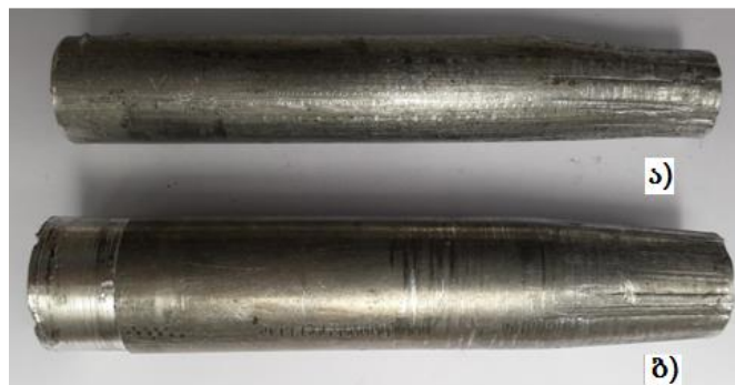
ნახ. 39. დეფორმირებული ნიმუშები ა - ალუმინის; ბ - დურალუმინის
