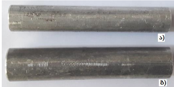
ნახ. 38. საცდელი ნიმუშები ა - ალუმინის (Φ20 მმ); ბ - დურალუმინის (Φ24 მმ)
