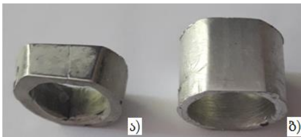
ნახ. 42. ტემპლეტები მიკროშლიფებისათვის: ა- ალუმინი A6; ბ - დურალუმინი D16
