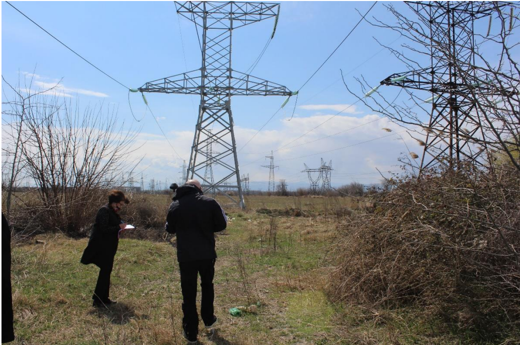
ნახ.4.9. საჰაერო ელექტროგადაცემის ხაზის ელექტრომაგნიტური ველის დამაბულობების გაზომვის პროცესი ხაზის გასწვრივ
