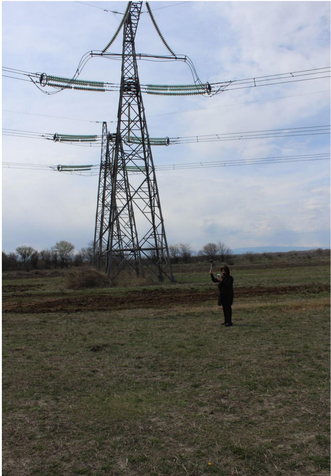
ნახ.4.6. ელექტრომაგნიტური ველის დამაბულობების გაზომვის პროცესი ხაზის მოხვევის კუთხის ბისექტრისის გასწვრივ
