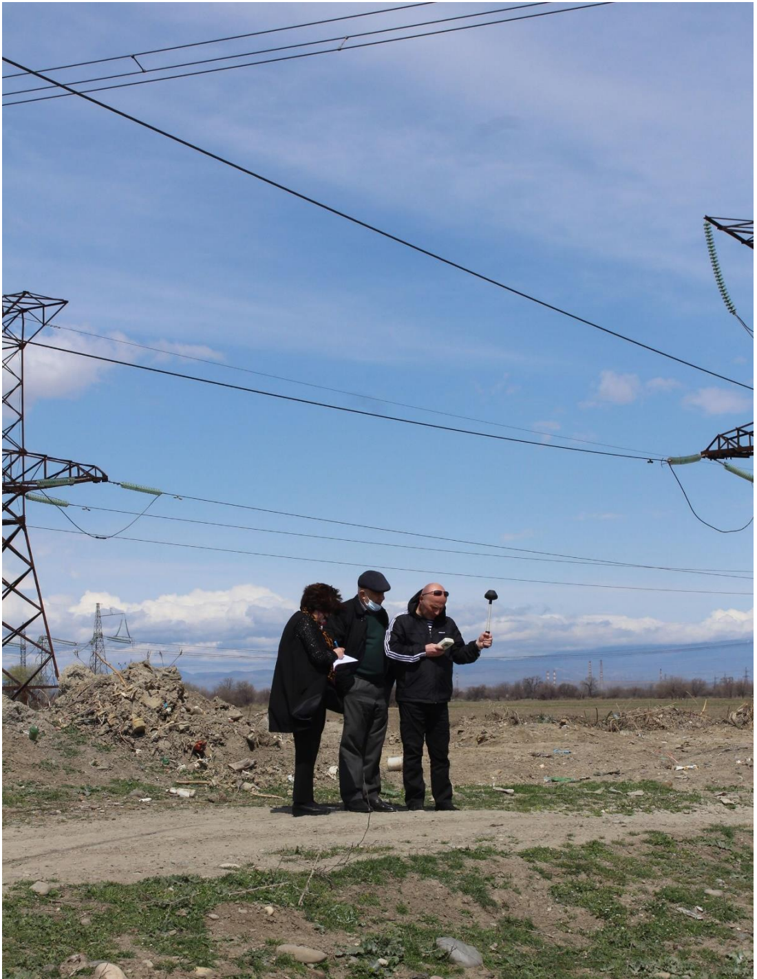
ნახ.4.3. საჰაერო ელექტროგადაცემის ხაზის ელექტრომაგნიტური დაძაბულობების გაზომვის პროცესი კიდურა ხაზის გეგმილიდან დაშორებაზე
