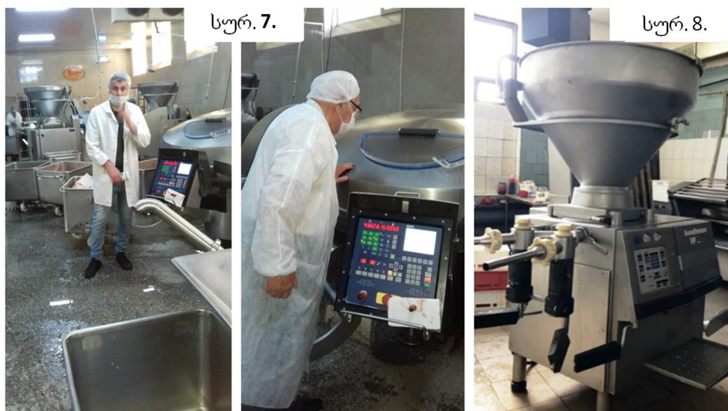
სურ. 7. ვაკუუმ-კუტერ Laska KU 200 v-ზე ფარშის დამუშავება; სურ. 8. შნეკური ვაკუუმ შპრიცი Handtmann VF 620
