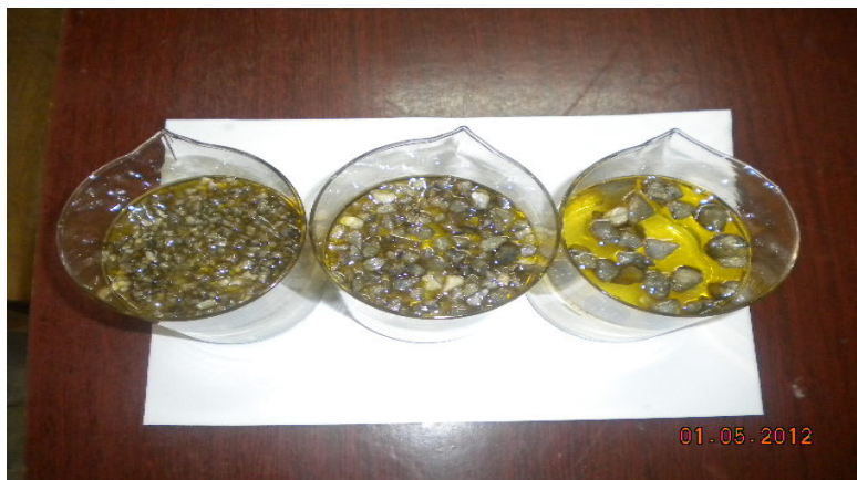
Рис. 2. Химические стаканы со смесью нефтепродуктов и вспученным обсидианом
