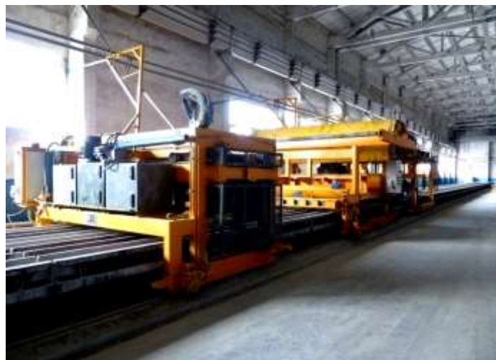
სურ. 13 დანადგარი, რომელიც უზრუნველყოფს ორთქლის გამკვებამდე სპეციალური ტილოს გადაფარებას კასეტურ ფორმებზე
