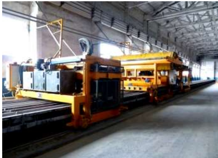
სურ. 13 დანადგარი, რომელიც უზრუნველყოფს სპეციალური ტილოს გადაფარებას კასეტურ ფორმებზე ორთქლის მიწოდებამდე
