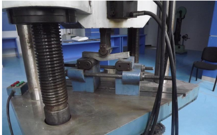
სურ. 4. ბაზალტის პოლიმერული კომპოზიტის ნიმუშის ღუნვის სიმტკიცეზე გამოცდა.
