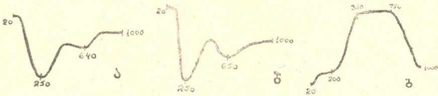
თერმოგრამა 1. კრილი 1. ა—სიღრმე 0—10 სმ, ფრაქცია <0,001 მმ; ბ—სიღრმე 65—75 სმ, ფრაქცია <0,001 მმ; გ—სიღრმე 120—130 სმ, ფრაქცია— 0,001 მმ.
