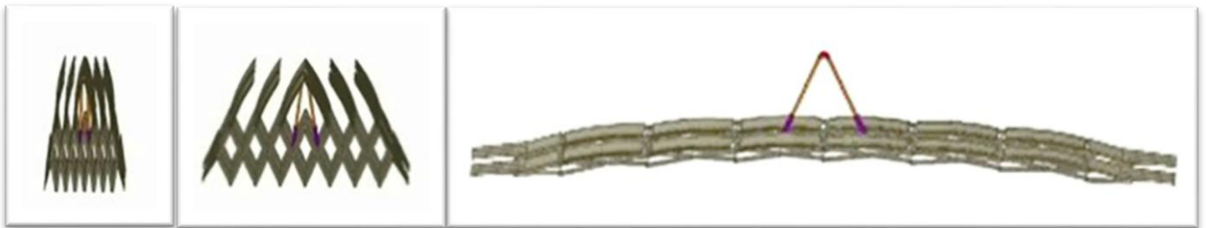
ფიგ. 12 – დასაკეც-გასაშლელი ხიდის სქემა, რომელშიც სავალი ნაწილის ფილები და ხიდის მზიდი კარკასი დაკეცილ მდგომარეობაში განცალკევებულია, ხოლო გაშლილ მდგომარეობაში ერთობლივად ითვისებენ კონსტრუქციაში წარმოქმნილ ძალებს.
