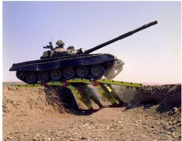
ფიგ. 17 – მრავალჯერადი გამოყენების სწრაფადასაგები საცდელი ხიდი მონტაჟის და ექსპლოატაციის დროს
