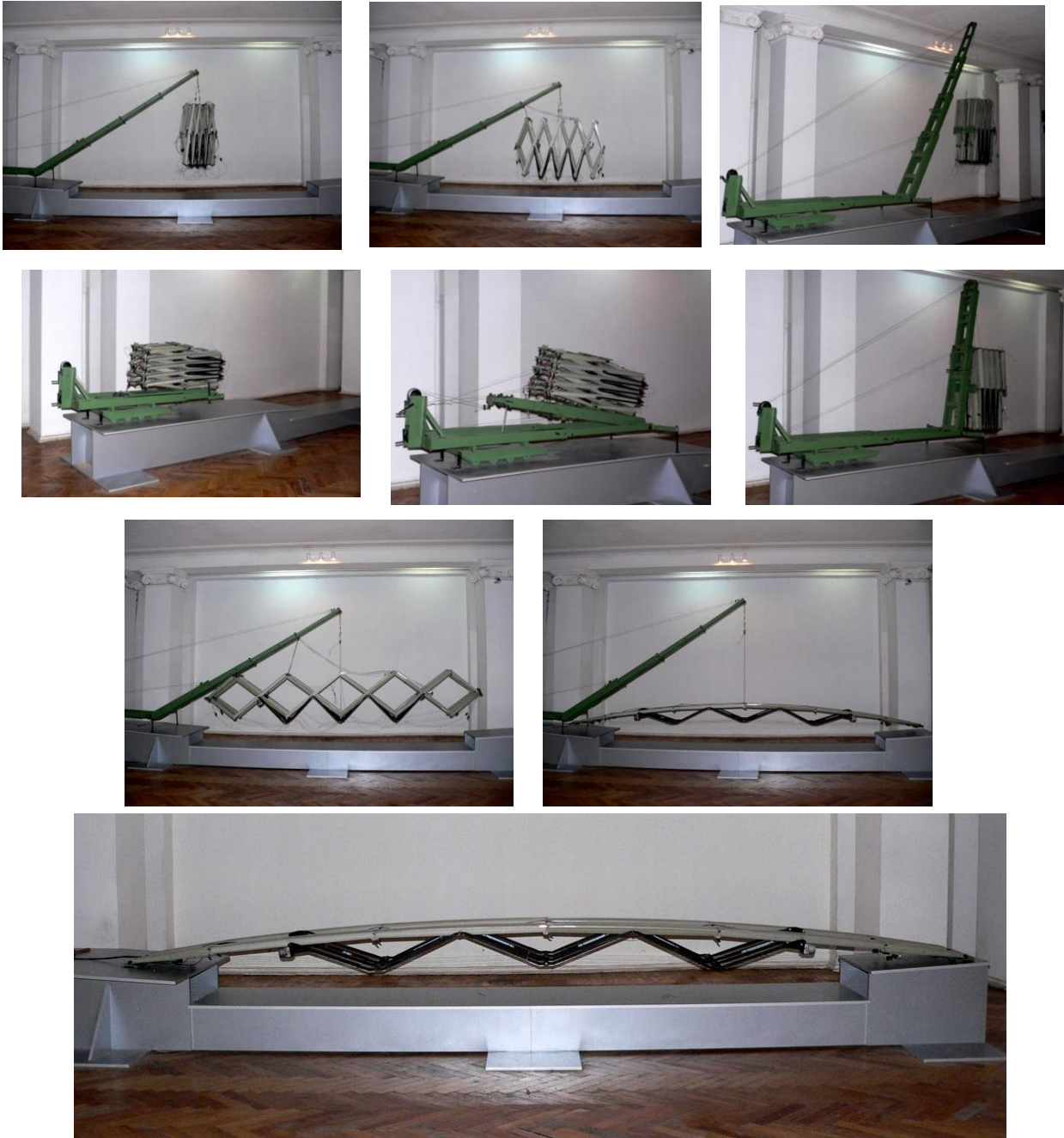
ფიგ. 13 – სავალი და მზიდი კარკასის შერწყმით შექმნილი, 48 მეტრი მაღის მქონე, ტანკზე განთავსებული, “საიერიშო” ხიდის დაბრკოლებაზე გაშლის ეტაპები
