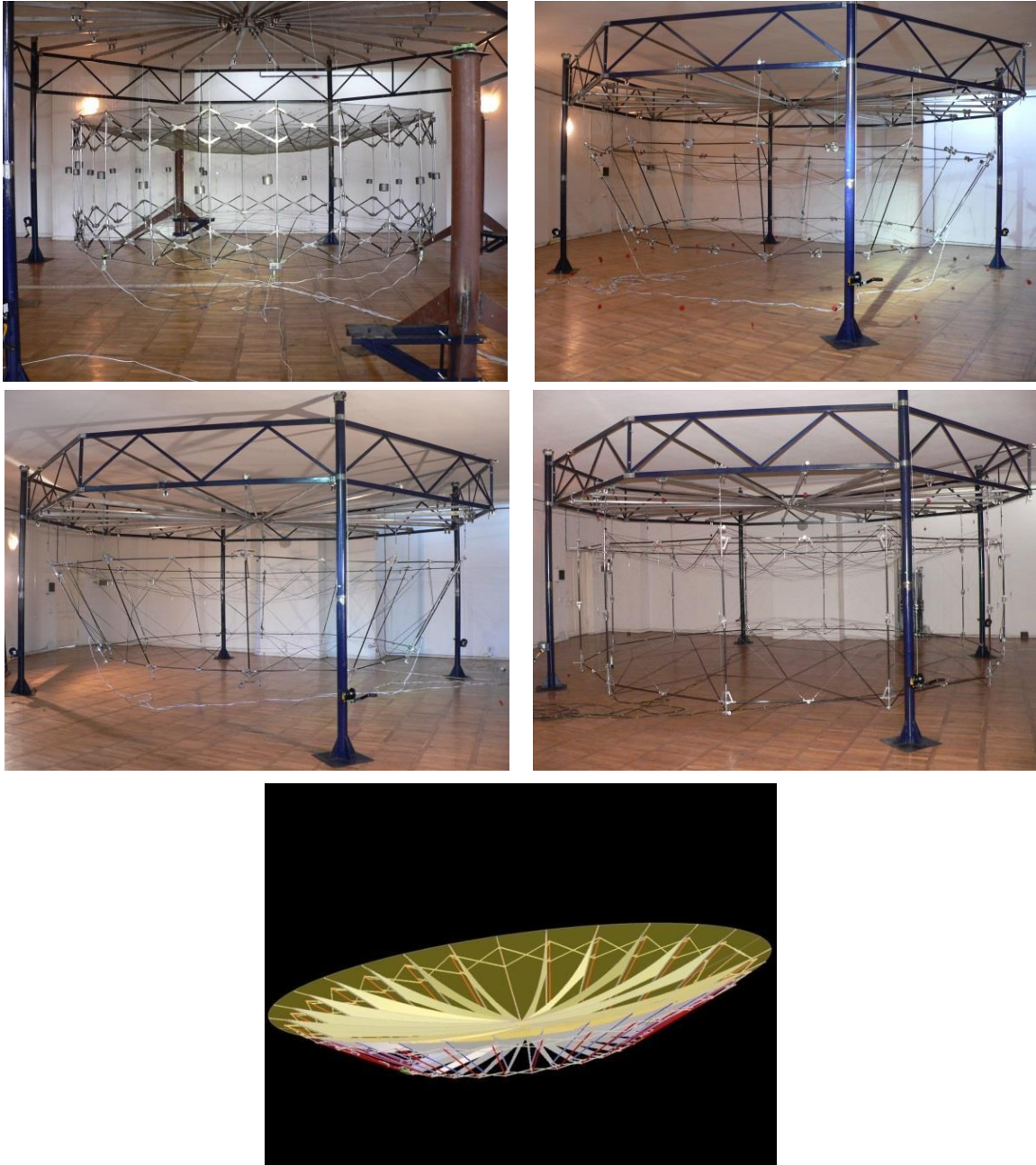
ფიგ. 3 – “ESA” დაფინანსებით საქართველოში შექმნილი დიდი კოსმოსური, გასაშლელი სისტემები, რომელთა პრიორიტეტია – მაქსიმალური სიმსუბუქე, სიზუსტე, სიხისტე და მინიმალური გაბარიტები დაკეცილ მდგომარეობაში.
