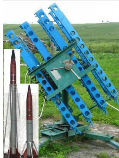
სურათი დ3-3. პირველი თაობის სეტყვასაწინააღმდეგო რაკეტა „ალაზანი-2M“-ისა და გამშვები დანადგარი ТКБ-040-ის საერთო ხედი
