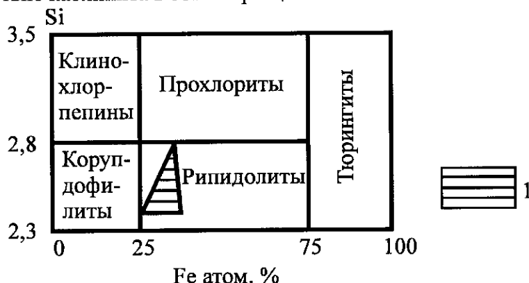
Рис. 33. Классификация хлоритов, основанная на парагенетическом принципе (Кежежинскас, 1965).
