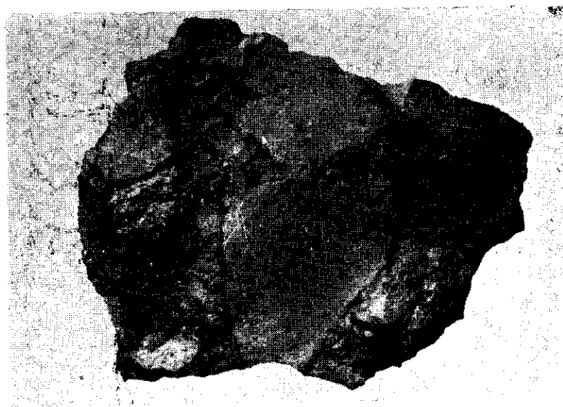
Рис. 2. Баритовая брекчия. Кластический материал брекчи—вторичный кварцит, цемент—барит. Уменьш. 2 X
