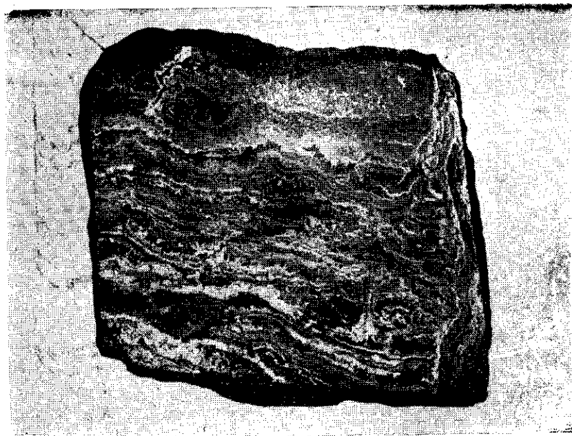
Рис. 1. Полированный штуф колломорфно-полосчатой руды. Белое—пирит, светло-серое—галевит, серое—сфалерит, темно-серое—барит. Нат. величина
