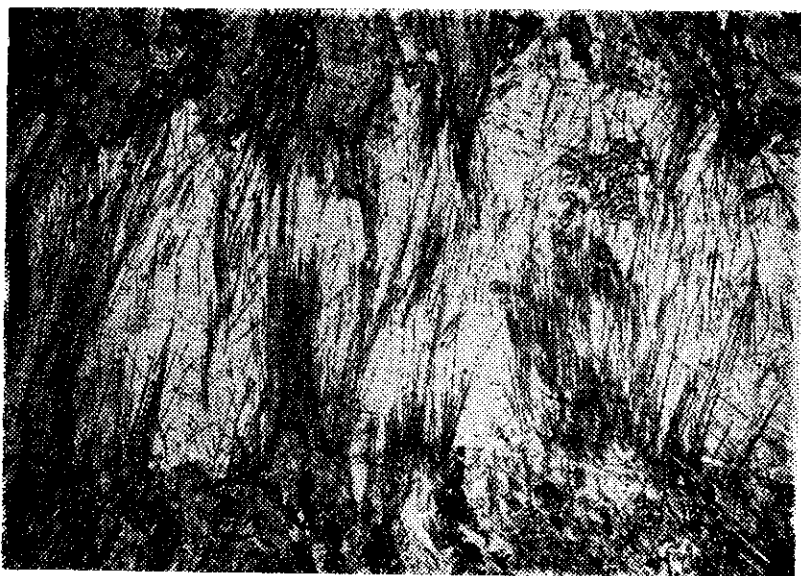
Рис. 6. Лучистый актинолит в альбите. Обр. № 69. Увел. 45, николи параллельны
