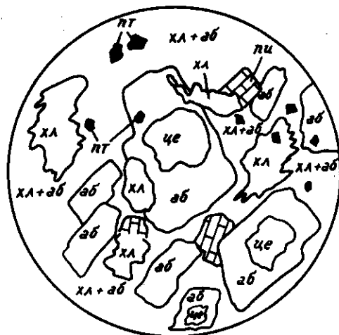
Рис.13. Зарисовка прозрачного шлифа р 379, отражающая альбитизацию по цеолитизированному плагиоклазу.
