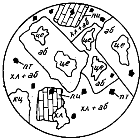
Рис.16. Зарисовка прозрачного шлифа З103, иллюстрирующая замещение альбитом предварительно цеолитизированного плагиоклаза.
