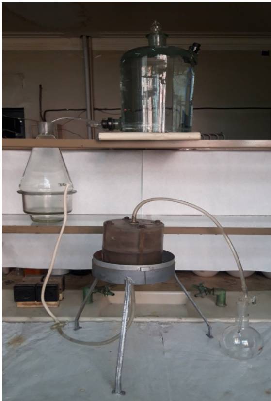
სურათი 4. დაბინძურებული წყლის გაწმენდა ჰიბირდული ნანოკომპოზიტის გამოყენებით
