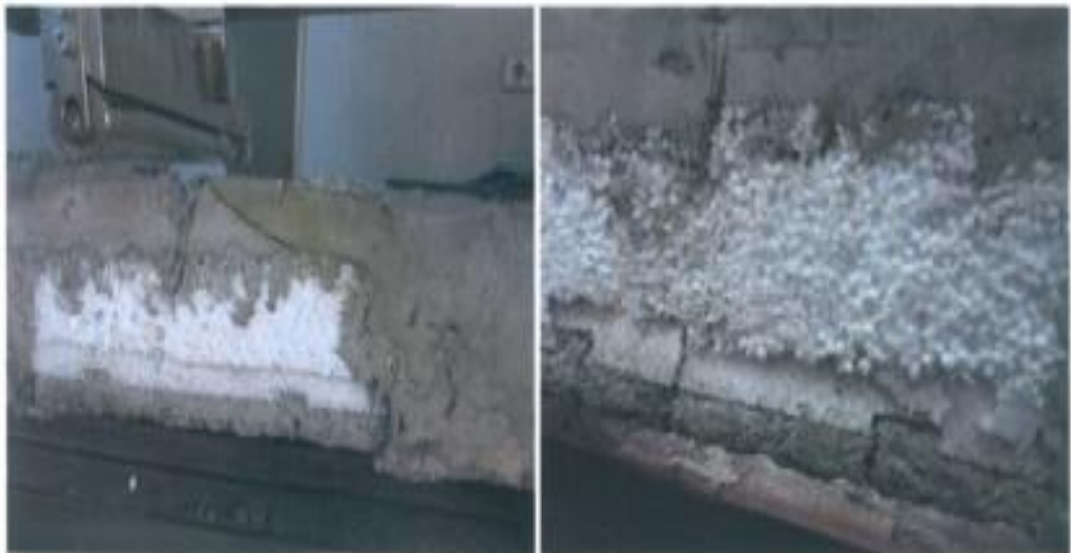
ნახ. 3.1.4 რკინაბეტონის კოჭის ტრიგონის ფრაგმენტის ღუნუნვაზე გამოცდა
