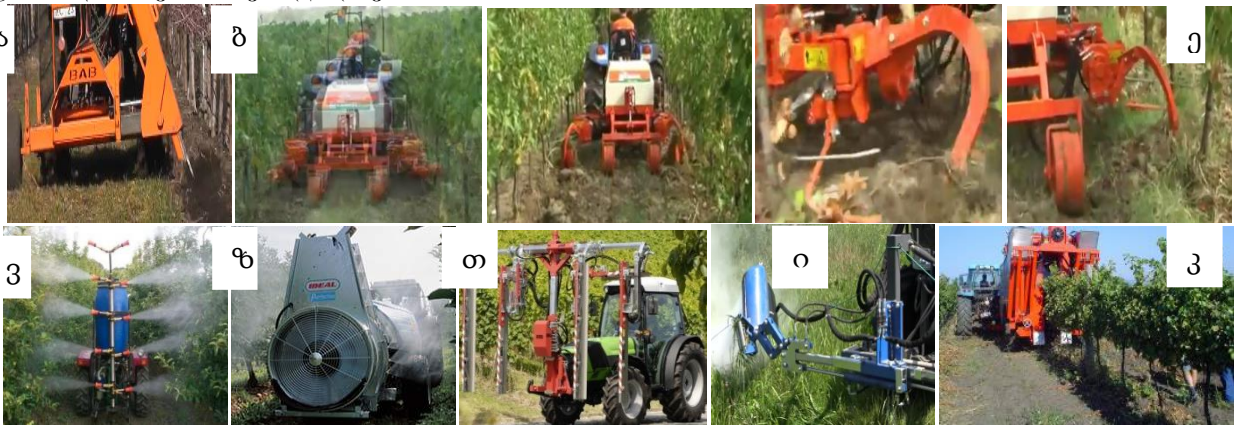
სურ. 1. ვენახის დამუშავების ოპერაციები: ა. ნიადაგის ღრმად დამუშავება ვიბრაციული სამუშაო ორგანოთი; ბ. ნიადაგის ზედაპირული გაფხვიერება აქტიური სამუშაო ორგანოთი; გ, დ, ე. ვენახში ძირების გამოხვნა; ვ, ზ. ვაზის შეწამვლა; თ. ვაზის ყლორტების გადაჭრა; ი. ვაზის რიგში ბალახის ორთქლით დამუშავება; კ. ყურძნის მექანიზირებული კრეფა.
