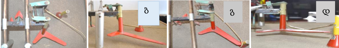
სურ. 12. საბრუნე თათის მოდელები სხვადასხვა მდგომარეობაში: ა. გაშლილი; ბ. შემობრუნების დაწყებამდე; გ. და დ. შემობრუნებული.
