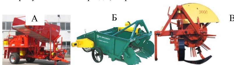
Рис. 1. Машины для Уборки Корнеплодов: А. Комбайн с лемехом, Б. Машина с лемехом, В. Машина с роторным копателем.
