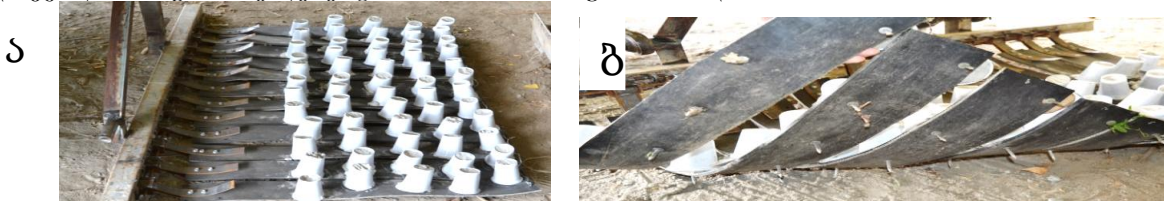
სურ. 2. დამზადებული ადაპტური გამაფხვიერებელი ფარცხი საველე გამოცდის შემდეგ: ა-ხელი ზემოდან, ბ-დრეკადი სამუშაო ელემენტები, გამაფხვიერებელი კბილებით.
