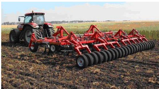
სურ. 1. ნაწვერალის დასამუშავებელი კულტივატორები “Landmaster” (გერმანია) “John Deere-726” (აშშ)
