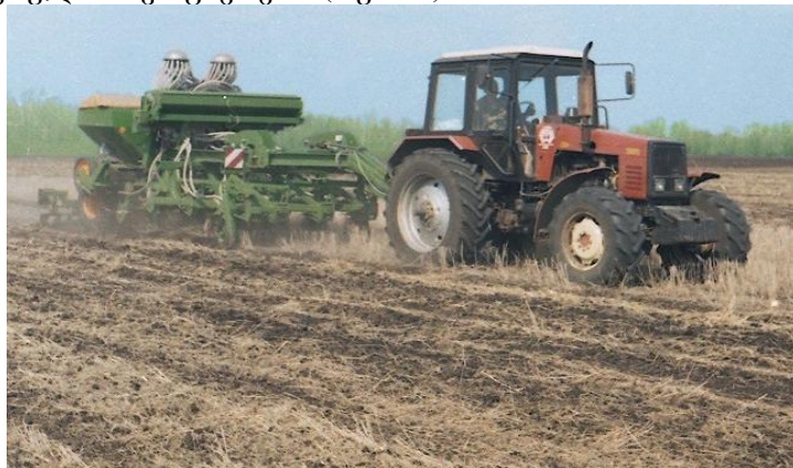
სურ. 2. ნაწვერალზე პირდაპირი თესვის აგრეგატი “Amazone” (ნულოვანი დამუშავების ტექნოლოგია)
