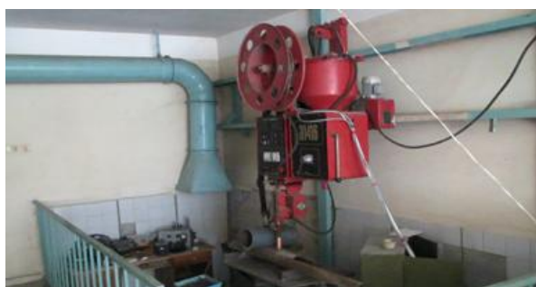
Рис. 3 Общий вид установки для автоматической наплавки лемехов плугов под слоем флюса.
