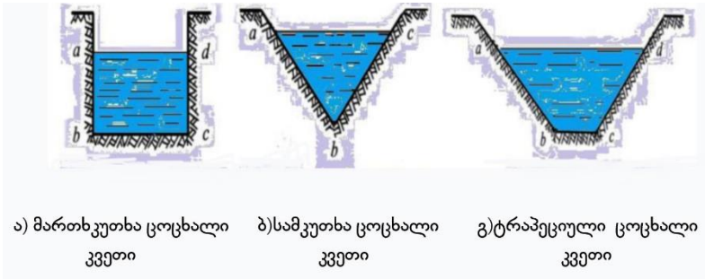
ნახ.4.5.1. არხების ცოცხალი კვეთი გეომეტრიული ფორმების მიხედვით
