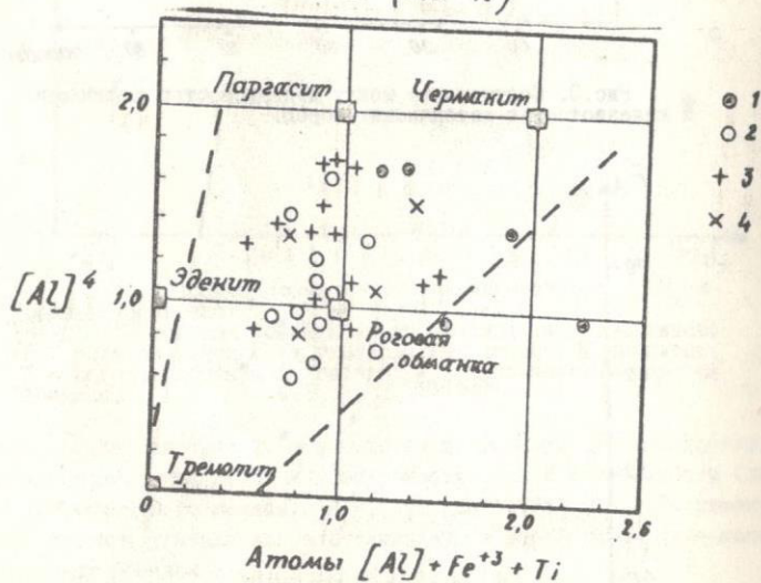
Рис. 5 и 6. Составы роговых обманок. 1 - сине-зеленая роговая обманка; 2 - роговая обманка из амфиболитов и метабазитов; 3 - роговая обманка из габбро; 4 - роговая обманка из гнейсовидных кварцевых диоритов.
