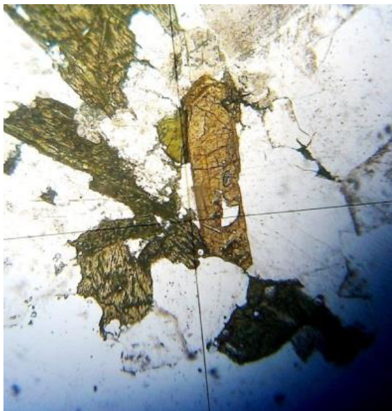
სურ. 1. ალანტის პრიზმული კრისტალი ბიოტიტ-რქატყუარიან გრანიტში. ერთ ნიკოლში. 3.7X8.
