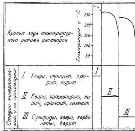
Рис.3. Схема последовательности выделения и температурного режима минералов.
