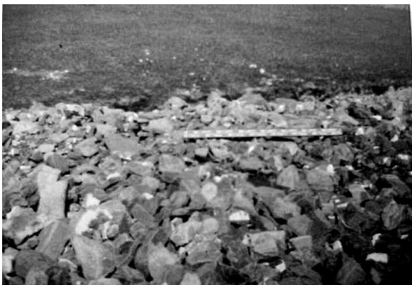
სურ. 4. სატრანზიტო ზონის დასასრულს დალექილი კალაპოტწარმომქმნელი ნაწილაკები
