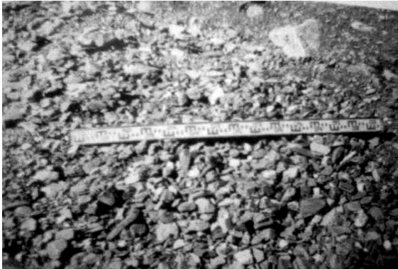
სურ. 3. სატრანზიტო ზონის შუაწელის შემდეგ დალექილი კალაპოტწარმომქმნელი ნაწილაკები
