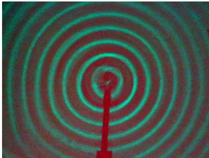
სურათი 2. წყლის ზედაპირის მახლობლად მის მართობულად ბურთულის რხევით გენერირებული წრიული ტალღების გამოსახულება ეკრანზე.
