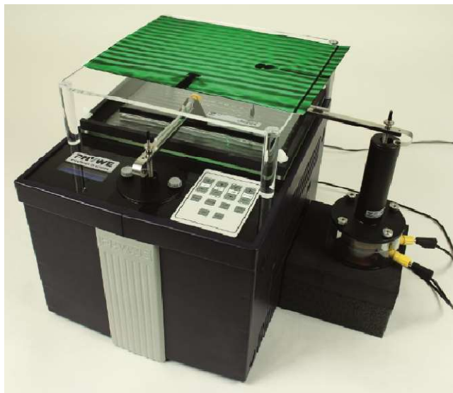
სურათი 4. წყლის ზედაპირზე ტალღების გავრცელების გამოსაკვლევი მოწყობილობის Ripple Tank with LED Light Source – Complete 11260 – 88 გარეგნული სახე.
