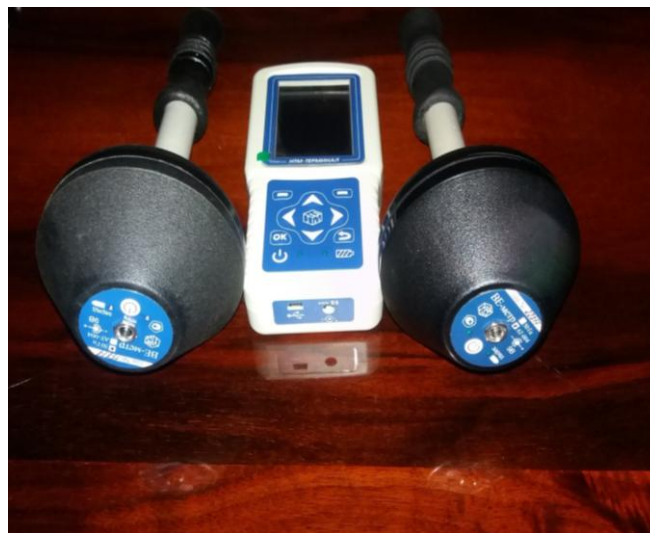
ნახ.9. მრავალფუნქციური უნივერსალური საზომი სამკომპონენტო ხელსაწყო BE-METP-ის საერთო ხედი
