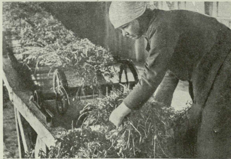
Искусственная сушка сена. Подача люцерны на транспортер сушильной установки.
