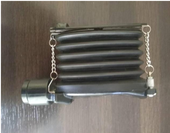
სურათი 17. AM-5 ტიპის ასპირატორი (ქიმიური აირგანმსაზღვრელი)
