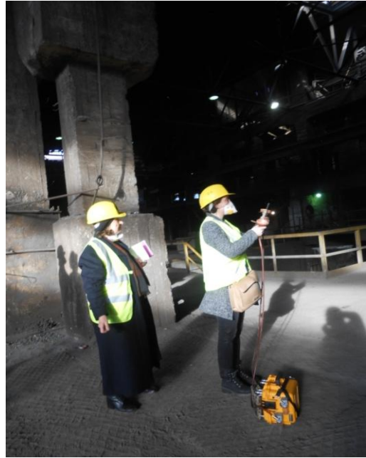
სურათი 12. მტვრის კონცენტრაციის განსაზღვრა სამუშაო ზონის ატმოსფერულ ჰაერში
