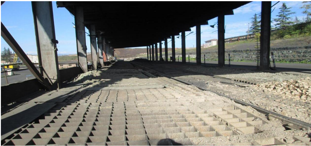
სურათი 3. უბანი, სადაც ხდება ფრაქციების მიხედვით დანაწილება
