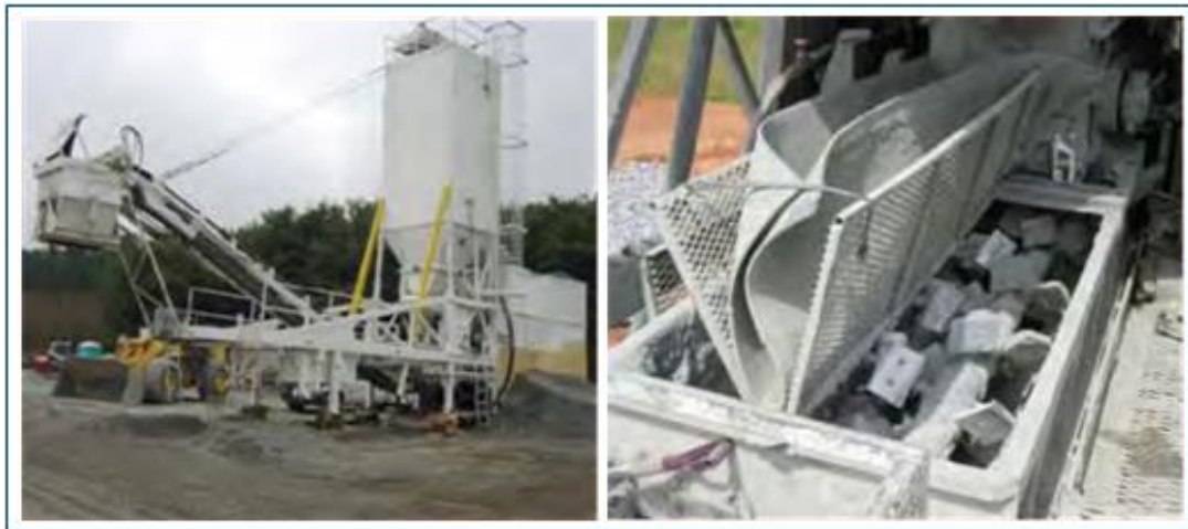
სურ. 4.5 ჰორიზონტალურ ბუნკიანი შემრევი (მარცხნივ) და შემრევი ახლო ხედი (მარჯვნივ)
