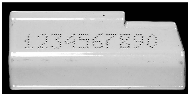
Фото № 1. Маркировочные знаки, выполненные иглоударной установкой на боковой стороне запорно-пломбирочного устройства
