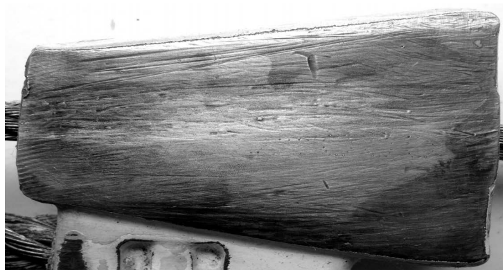
Фото № 2. Удаление маркировочных обозначений на ЗПУ ТП-2800 абразивным инструментом на глубину 1 мм
