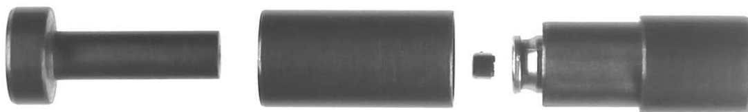
Иллюстрация № 4. Комплект приспособлений предназначенный для монтажа капсюля в капсюльное гнездо гильзы 9 × 22 мм травматического патрона состоящий из четырех предметов № 5,6,3,1
