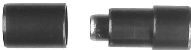
Иллюстрация № 7. Комплект приспособлений предназначенный для заключительного этапа сборки (обжима дульного среза гильзы) травматического патрона 9×22 мм состоящий из трех предметов № 7, 1, 2
