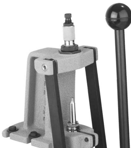
Иллюстрация 1. Патронно-сборочный пресс заводского изготовления, приводимый в действие рукой при помощи рычага с установленным дополнительным оборудованием: нексайз-матрицей (используется для обжима дульца вверху) и шелхолдером (гильза-держателем с гильзой внизу)
