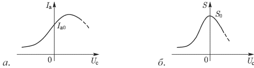
ნახ.7.4. ა) ანოდური დენისა და ბ) ბადური სიმრუდის, ბადურ ძაბვაზე დამოკიდებულების გრაფიკები
