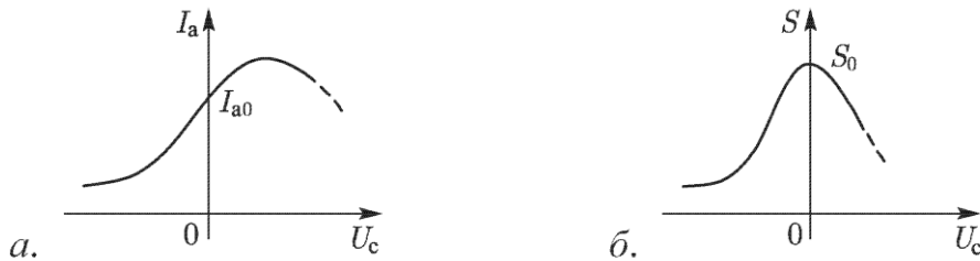
ნახ. 3.20. ა) ანოდური დენისა და ბ) ბადური სიმრუდის ბადურ ძაბვაზე დამოკიდებულების გრაფიკები
