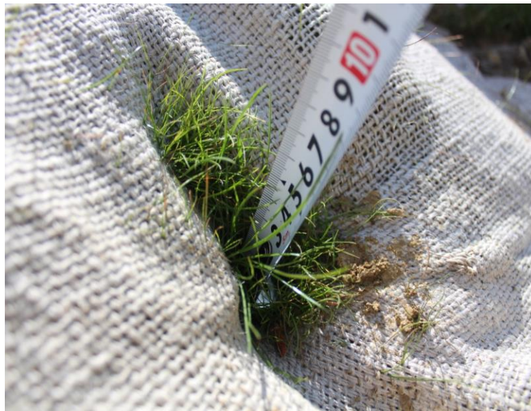
ფოტო 2. გეოხალიჩა “Jute Mat”-ზე ამოსული მცენარეების სიმაღლის გაზომვის პროცესი
