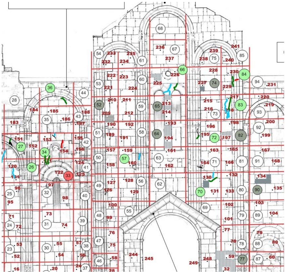
ნახ.2. ჩრდილოეთ ფასადის კედლის ტექნიკური კვლევის რუკა დაზიანებებითა და საკვლევი წერტილებით.
