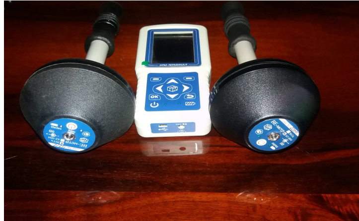
ნახ.2. მრავალფუნქციური უნივერსალური საზომი სამკომპონენტანი ხელსაწყო BE-METP-ის საერთო ხედი
