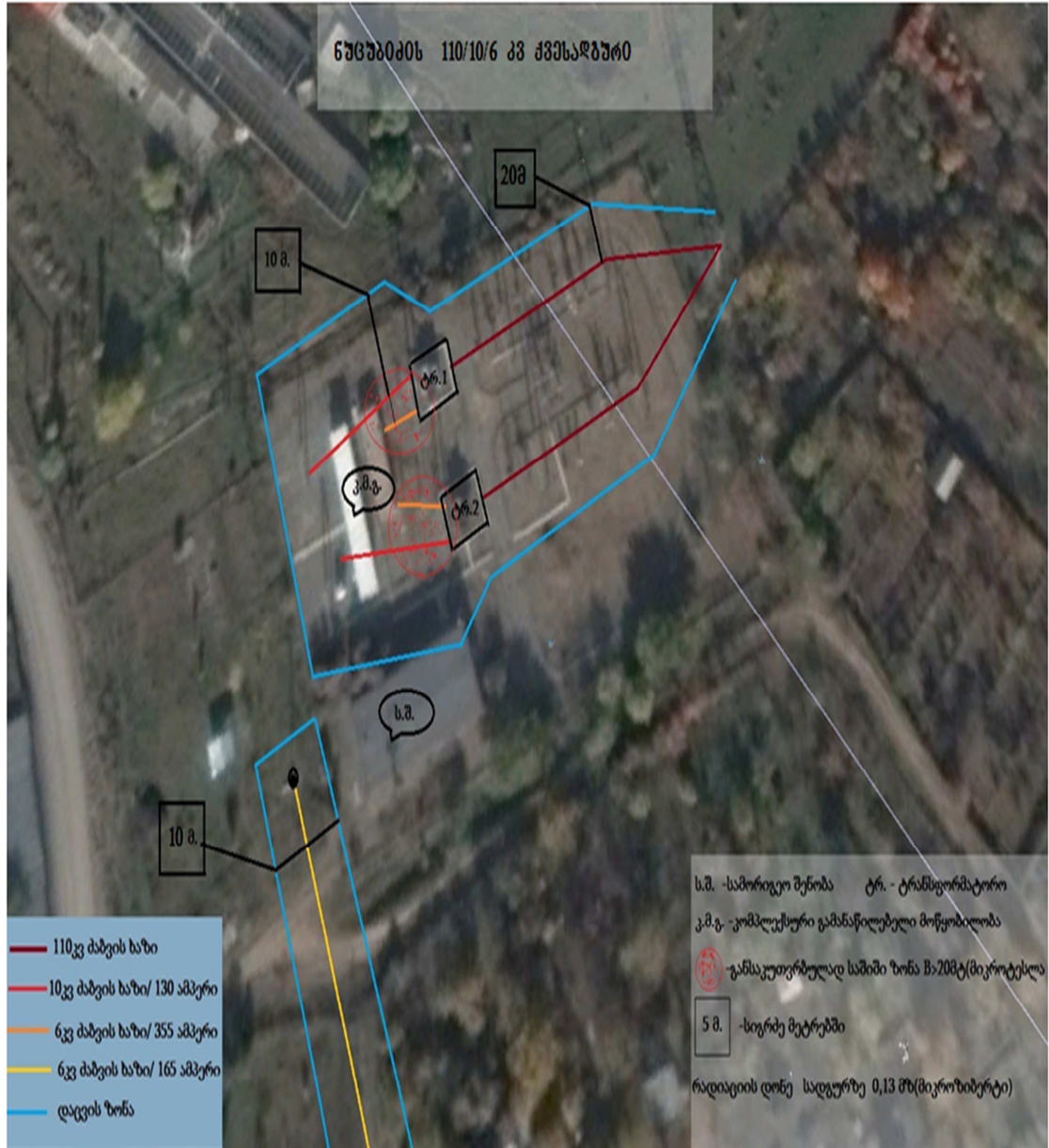
ნახ.4.3. ნუცუბიძის 110/10/6 კვ ძაბვის ქვესადგურის ხაზის დაცვის ზონები 4.2. ექსპერიმენტული კვლევები ავჭალაში.
