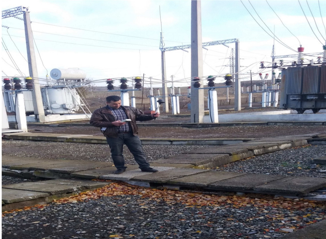
ნახ.4.2. ელექტრული და მაგნიტური ველების დამაბულობების გაზომვის პროცესი ნუკლებიძის 110/10/6 კვ ძაბვის ქვესადგურში.
