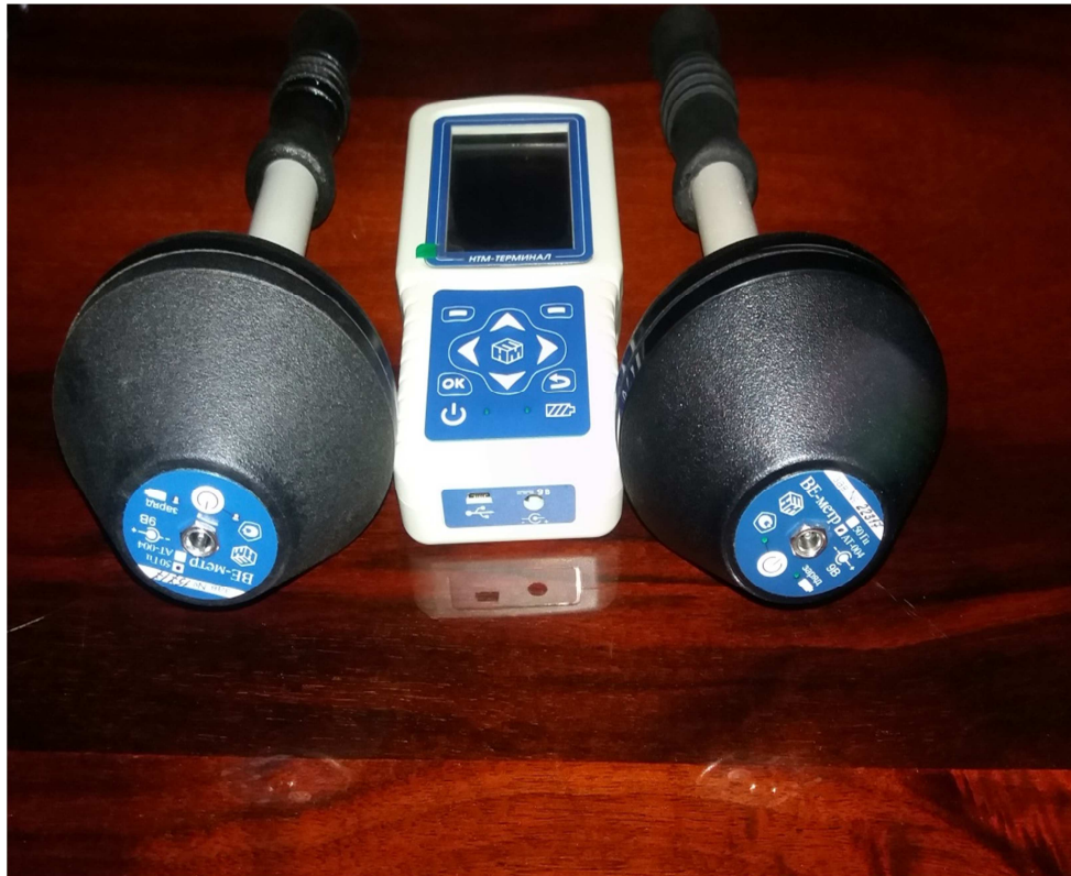
ნახ.2.1. მრავალფუნქციური უნივერსალური საზომი სამკომპონენტო ხელსაწყო BE-METP-ის საერთო ხედი
